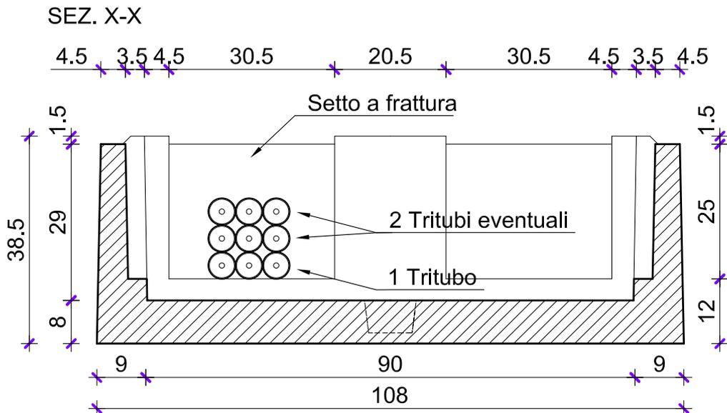
Pozzetto 90x70 – Pianta e Sezione
