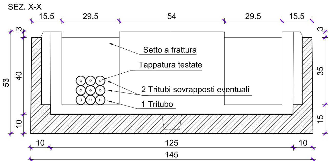
Pozzetto 125x80 – Pianta e Sezione
